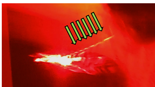
図4 レーザー光をあてると干渉縞が！
